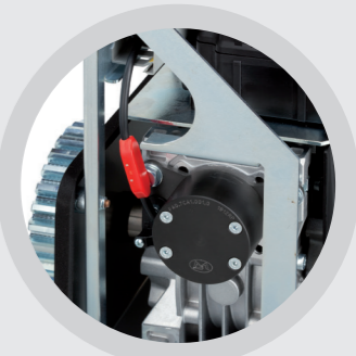
Tutma yerlerine sahip güçlendirici yan destekler operatörün taşınmasına ve konumlandırılmasına ve motor şaftında elektrik frenine yardımcı olur.
